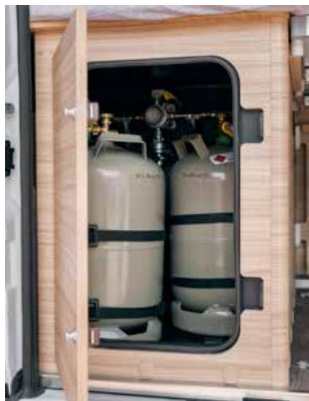
Gasflaschenkasten für zwei 11-kg-Gasflaschen (außer CLIFF 601 mit zwei 5-kg-Gasflaschen)
